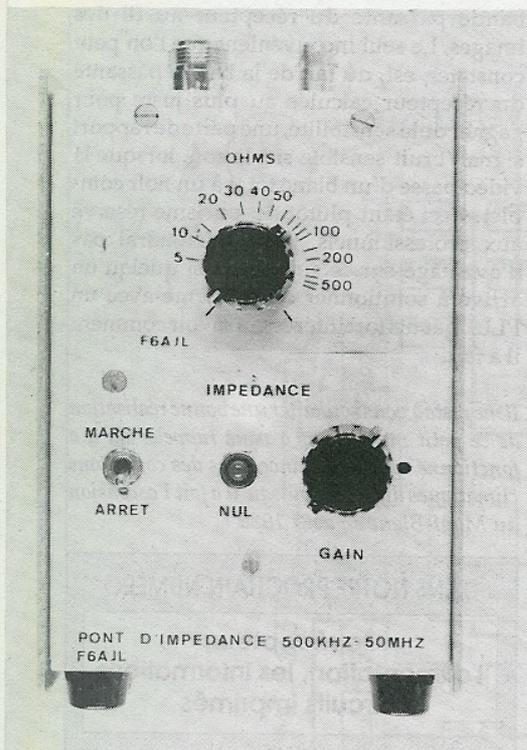
**L'**impédance d'antenne est un instrument de mesure permettant, comme son nom l'indique de mesurer l'impédance présentée par une antenne aux points de raccordement du câble de liaison.
